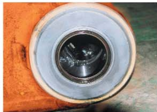
Pulverización en caliente WC (carburo de tungsteno)
